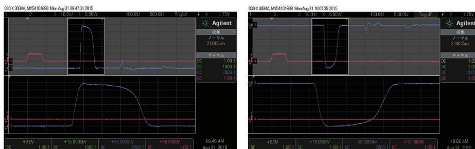
左側の青色の波形は正極性出力電圧波形。右側の波形は負極性出力電圧波形。両方とも縦軸は 10 kV/div。横軸は 100 ns/div。正極性、負極性ともピーク電圧は 60 kV で立上り時間は 40 ns。従来方式のパルスに比べて極めて高速の立上りを得ている
