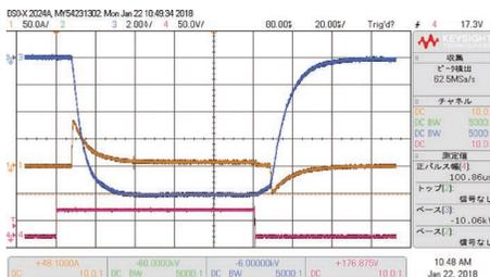
MARX 段数 40 段, 出力電圧 100 kV<sub>p</sub>, 出力電流 10 A<sub>p</sub>, パルス幅 150 μs, 繰返し 10 Hz
