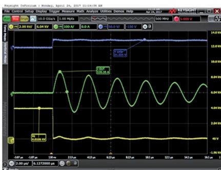
各波形写真において、黄色はドレイン電圧で(A), (B)は 5 kV/div, (C)は 2 kV/div. 緑はドレイン電流で, (A), (C)は 100 A/div, (B)は 10 A/div. 青はトリガ信号で 50 V/div. 時間軸は全て 2 μs/div
