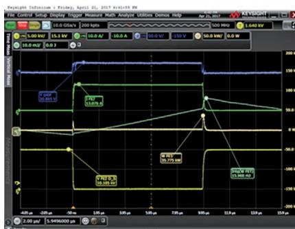
(C) ドレイン電圧 4 kV, ドレイン電流 135 A, 330kHz での振動波出力時の波形
