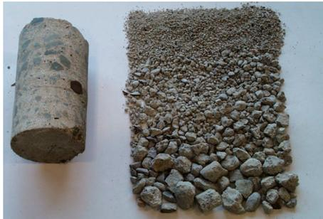
図4 水中に置かれたコンクリート(左側)にパルスパワーを印加した後、並べられた小石や砂利(右側)(P.5)
