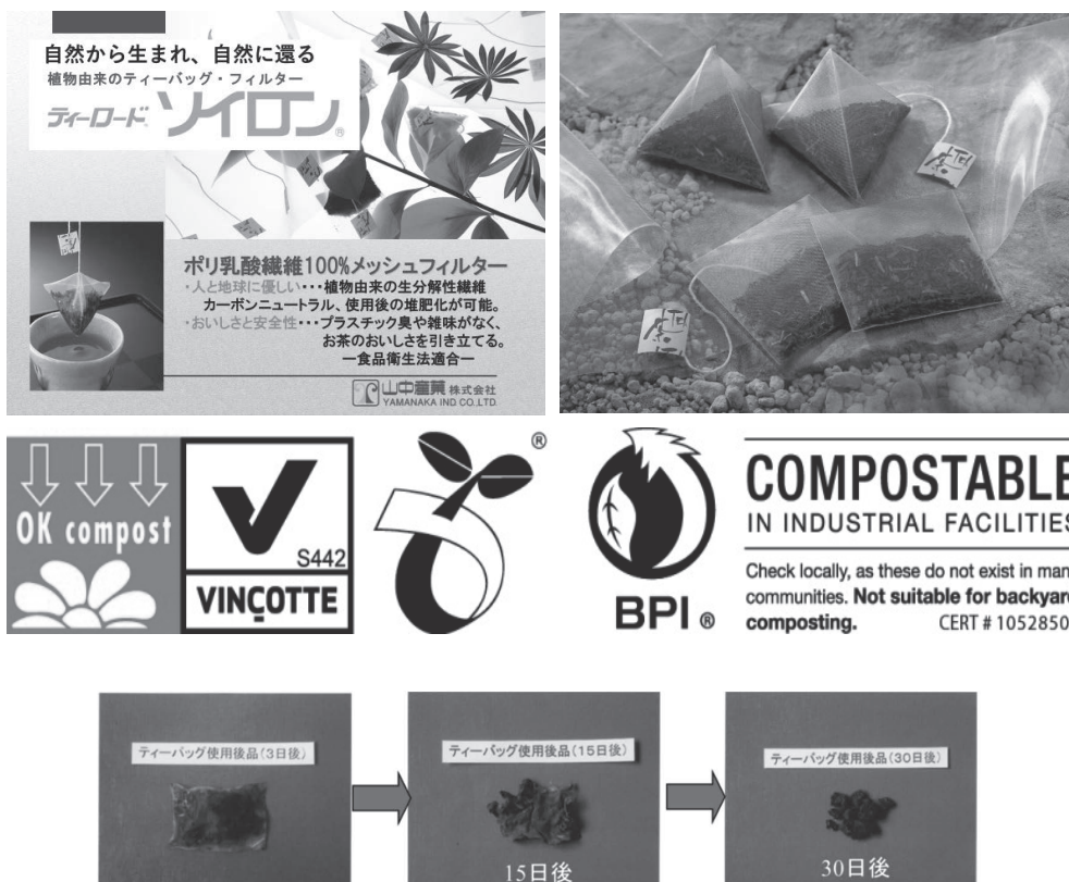
使用済ティバッグフィルターのコンポスト中での生分解挙動
