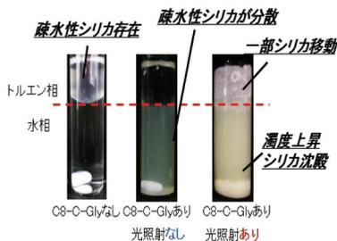
図 13 シリカ粒子の分散状態に及ぼす光開裂性界面活性剤 C8-C-Gly の影響 (p.614)
