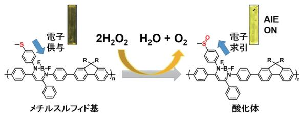
図6 AIE 性高分子を用いた過酸化水素検出のためのプラスチックセンサーの作動機構の模式図 (p.85)
