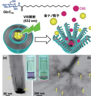
図7 GlcC<sub>18</sub> の化学構造式。GlcC<sub>18</sub> の二分子膜から成るナノチューブへの金ナノ粒子の複合化と光温熱機能を利用したナノチューブの崩壊及び包接化フラレンの放出を表した模式図。(a) 金ナノ粒子複合化ナノチューブの電子顕微鏡像。(b) 光照射により崩壊したナノチューブの電子顕微鏡像。(写真左) フラレンを包接したナノチューブの水分散溶液。(写真右) フラレンが沈殿した水溶液。(p.605)
