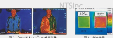
図2 「サーモトロン®」の着用試験 縫製品(左身頃:サーモトロン®,右身頃:ブランク)
